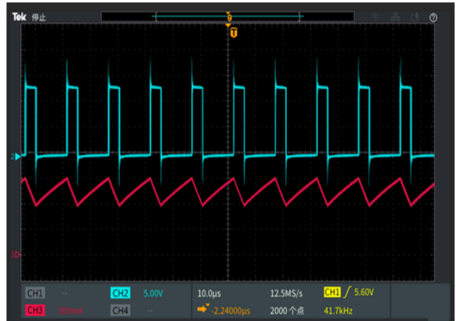
SW脚与电感电流工作波形
